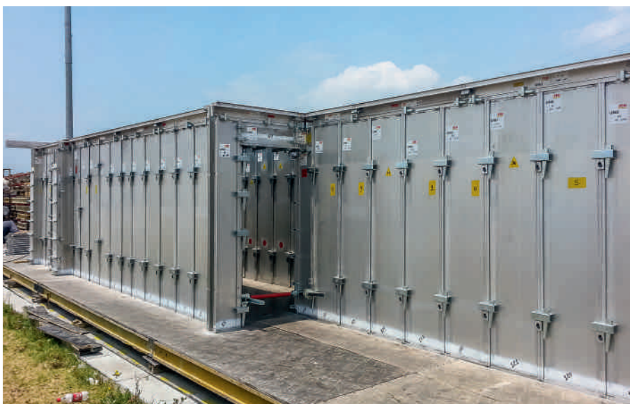
Antes de la entrega de cada juego de encofrado, PERI realiza un montaje de prueba, a fin de identificar y corregir en fábrica cualquier posible defecto.
